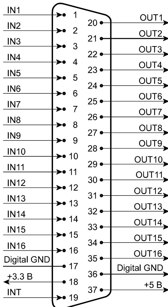
**Внимание!!!** Подключение к данному внешнему разъёму **DRB-37F** можно производить только при выключенном питании модуля **E14-440**. Необходимо внимательно следить за тем, чтобы в процессе эксплуатации не было случайных замыканий цепей **Digital GND** и **+5 В** или **+3.3 В**, иначе модуль может выйти из строя!!!
