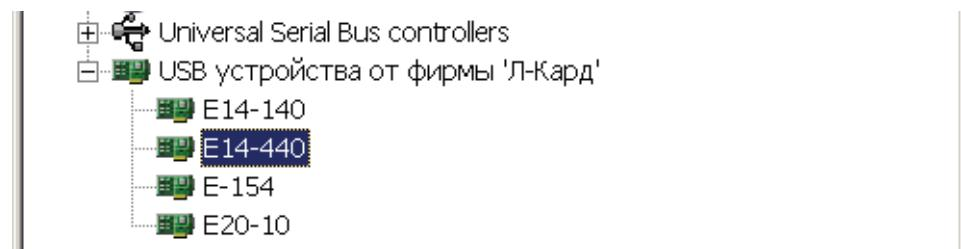
При дальнейшей работе с модулем **E14-440** операционная система уже будет знать, где находится драйвер для данного типа устройства, и будет подгружать его автоматически по мере необходимости при подключении изделия к компьютеру.
